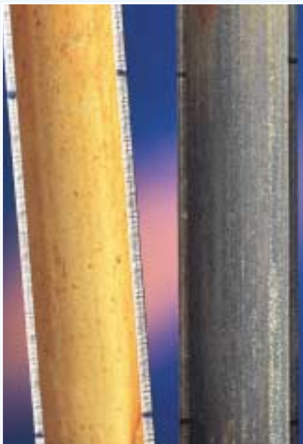
Korrosionsschutzbildung an verzinktem Rohr durch Mineralstoff-Dosierung (ungebeizt und gebeizt).
